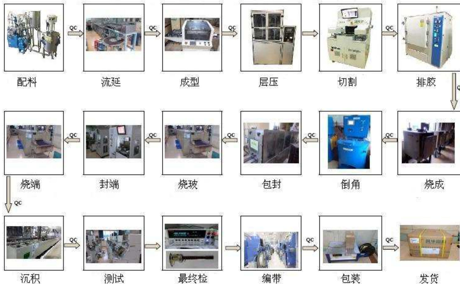
片式压敏、热敏电阻器生产流程图
