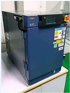
Espec 小型環境試驗箱 -65°C~150°C; 30%~95%RH
