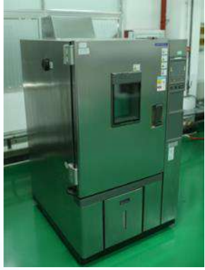
Espec 恆溫恆濕試驗箱 -40 °C~150 °C; 25%~98RH%
