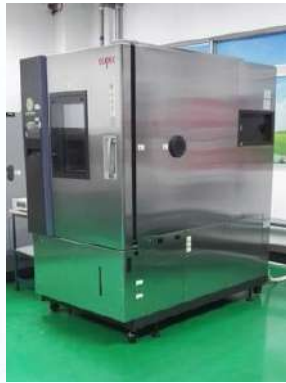
Espec 恆溫恆濕試驗箱 -75°C~180°C; 10%~98%RH
