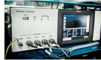
HIOKI 精密LCR電錶 具有極性測試能力
