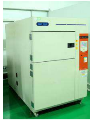
Giant Force 冷熱衝擊箱 -55°C~150°C
