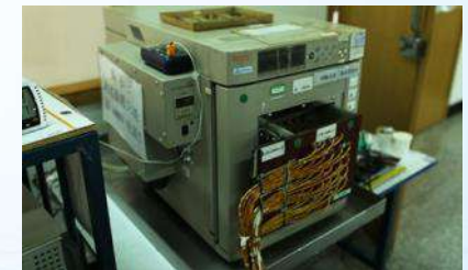
Espec 環境試驗箱鏡 低溫可達-60°C
