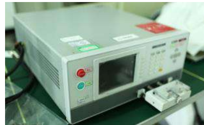
Chroma 線圈脈衝測試儀 最低電感量可測100nH
