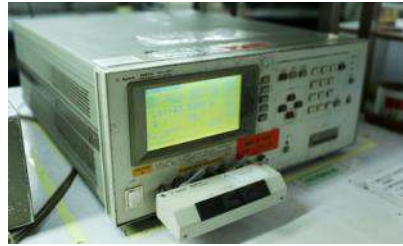
Agilent 精密LCR電錶 具有高達30MHz/±0.1精準度
