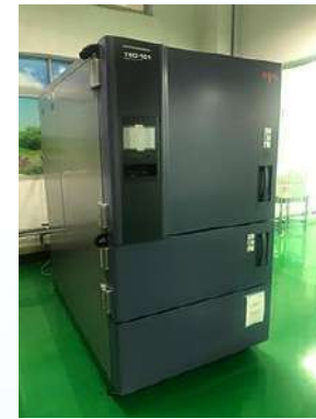
Espec 冷熱衝擊試驗箱 -77 °C~205 °C
