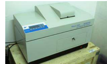
Jnwinner 激光粒度分析儀 最小測試微粒0.1μm
