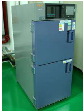
Espec 冷熱衝擊箱 -70°C~200°C
