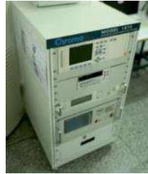
Chroma 磁性測試系統 直流重疊電流高達60A
