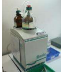
Ωmetrohm 離子色譜儀器 檢測所有產品鹵素含量
