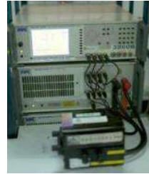
Wayne Kerr 電流源測試系統 直流重疊電流高達100A
