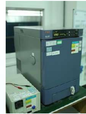
Espec 小型環境試驗箱 -60 °C~150 °C; 30%~95%RH
