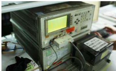
Agilent 精密LCR電錶 具有±0.05%的精準度
