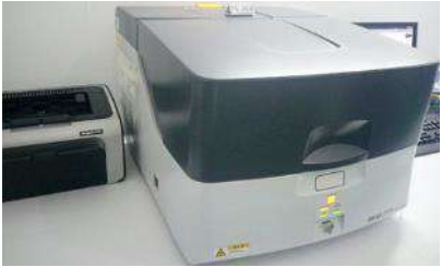
SHIMADZU 螢光光譜儀 測量ROHS指令中所有有害物質
