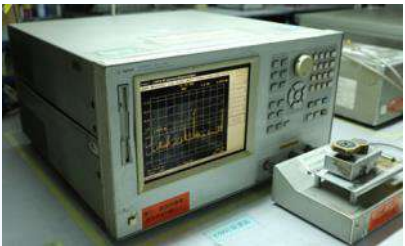
Agilent 阻抗分析儀 最大3GHz測試頻率
